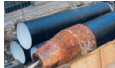
Modules de tubes courts coextrudés PE 80 pour intégration par procédé de Relining
