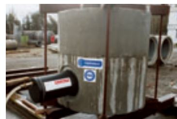
Contrôle de raccordement de puits
