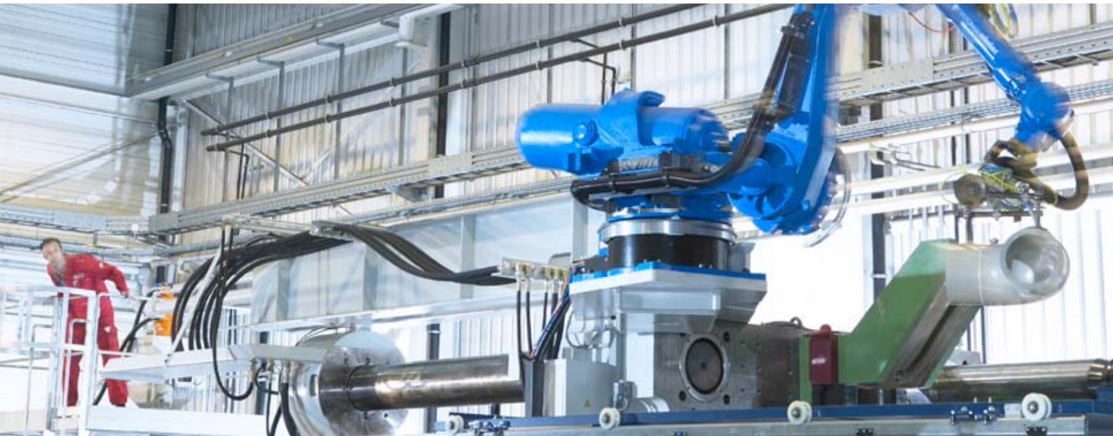
Une installation moderne de moulage sous pression pour la fabrication de raccords
