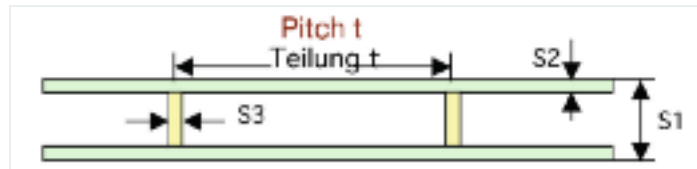
Bild 1: Schematischer Aufbau der SIMONA Hohlkammerplatte
