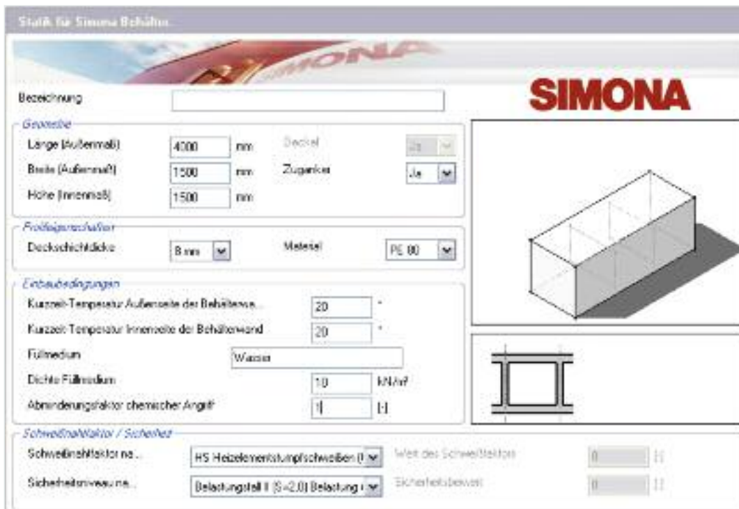
Bild 8: Auszug aus der Eingabemaske des Berechnungsprogramms. Die Eingangsparameter der numerischen Untersuchungen können im Programmsystem variiert werden.
