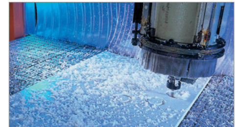
Fraisage CNC d'une plaque en matière plastique
